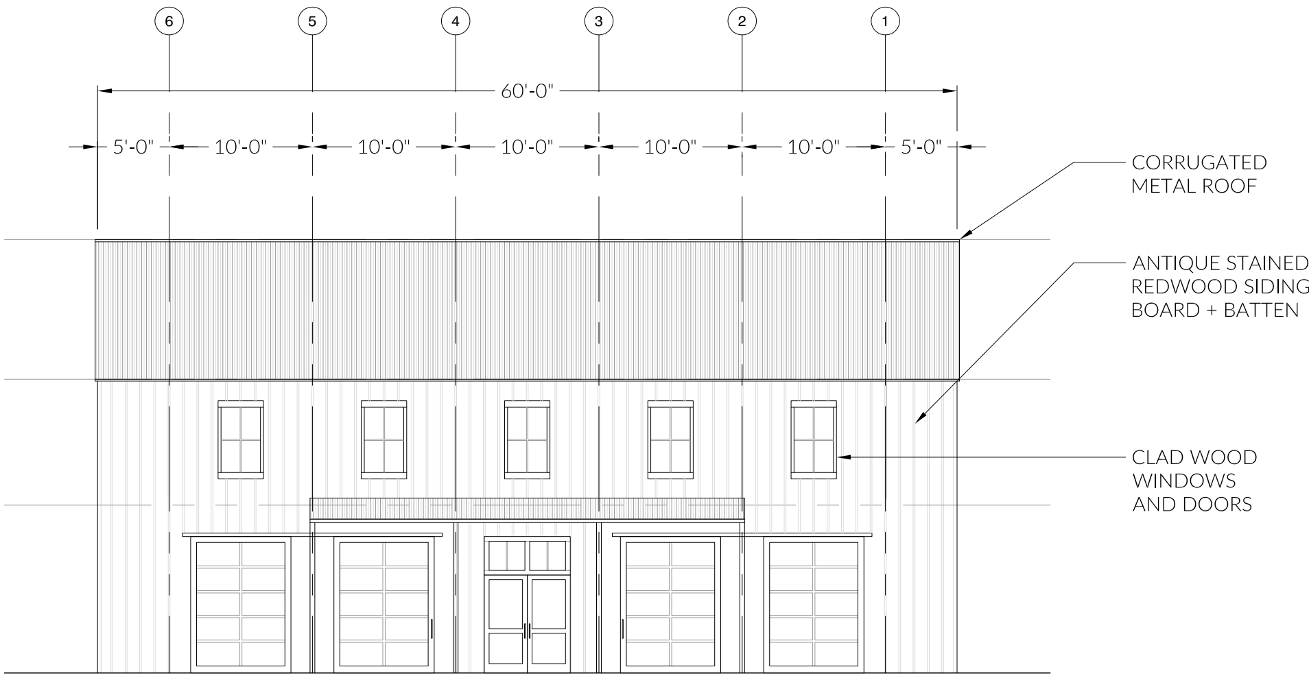
Barn Annex: East Elevation Scale: 1/8" = 1'-0"
