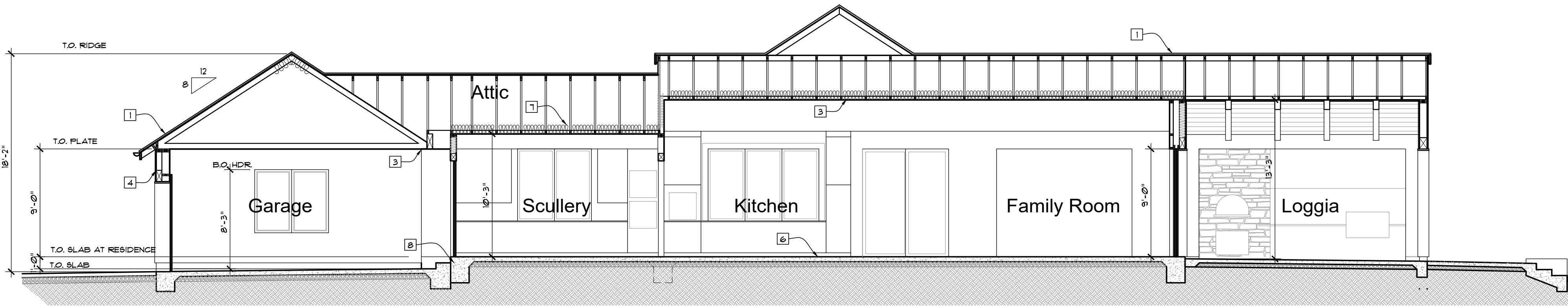
Section D: Longitudinal Section
